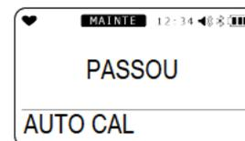
A concentração após a calibração automática é exibida.
