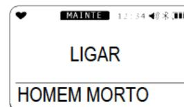
Pressionar o botão **AIR** permite selecionar LIGAR ou DESLIGAR para o alarme de homem morto. A configuração padrão é “DESLIGAR”.
