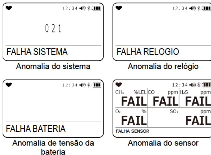
Se ocorrer um alarme de falha, determine a causa e tome as medidas adequadas.
